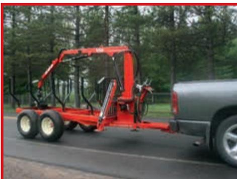
Chargeuse modèle 1200ST (portée maximale du mât : 12 pieds)
