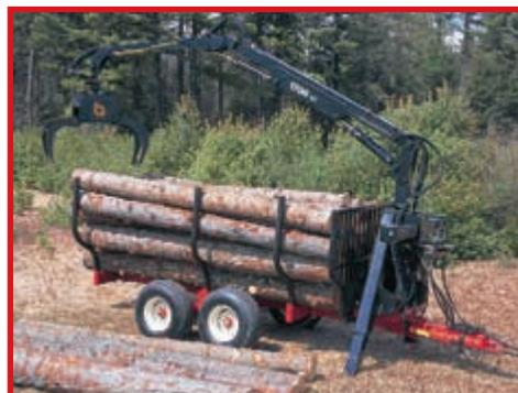
Chargeuse modèle 1700ST (portée maximale du mât : 17 pieds)
